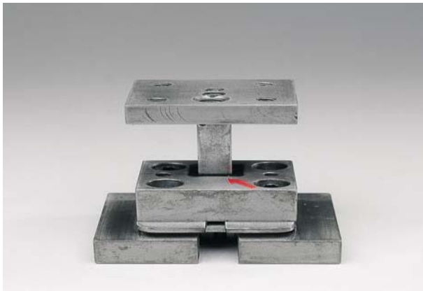
Fotografia 1 – Riparazione di una guida in una pressa
