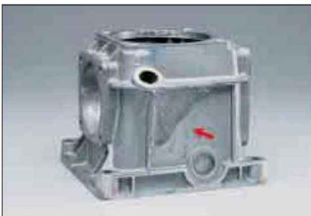
Fotografia 2 – Riparazione di una carcassa in alluminio
